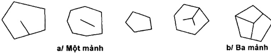
Hình 11 – Ví dụ về dạng mảnh vỡ của kính tôi nhiệt an toàn
